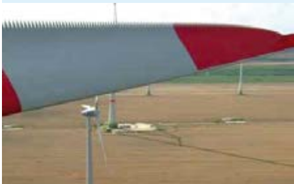
E-115 Rotorblatt mit Trailing Edge Serrations (TES) Die Zacken (Serrations) an den Flügelenden sind der Natur nachempfunden und bewirken eine höhere Energieausbeute, zudem sind die Flügelgeräusche leiser.
